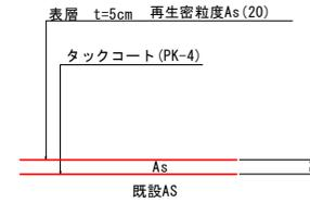
舗装段差すり付け詳細図 S=1/10
